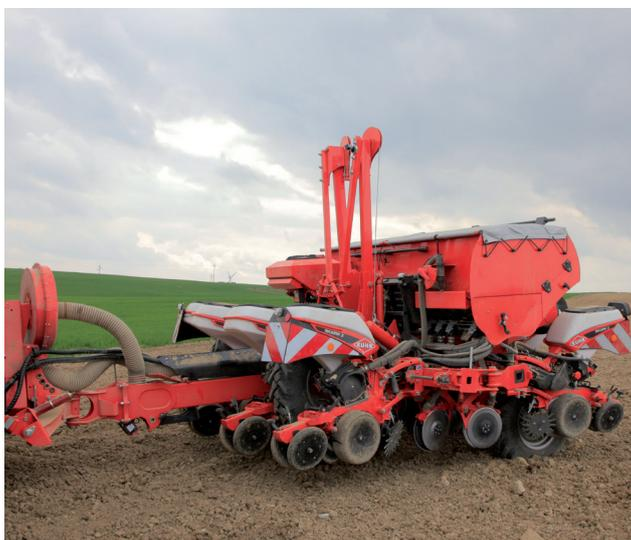
**Gezogener einklappbarer Rahmen in 8-reihiger Ausführung für Reihenabstände von 70 bis 75 cm. Transportbreite 3,00.**
