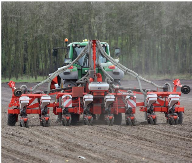
**Klapprahmen in 8-reihiger Ausführung für Reihenabstände von 70 – 75 – 80 cm. Transportbreite 3,00.**
