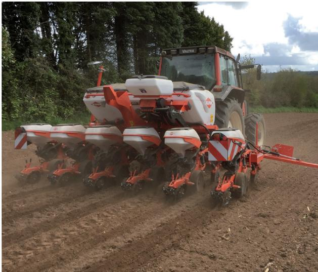
Teleskoprahmen in 6-reihiger Ausführung für Reihenabstände von 70-75-80 cm. Transportbreite 3,30 bis 3,50 m je nach Reihenabstand.
