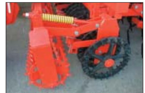
Optional: Crosskillausführung zur besseren Rückverfestigung bei schweren Böden.
