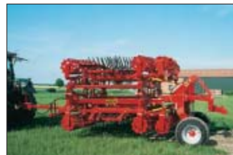
DRT 60 H geklappt: Kompakt mit hohem Aushub und guter Schwerpunktlage.
