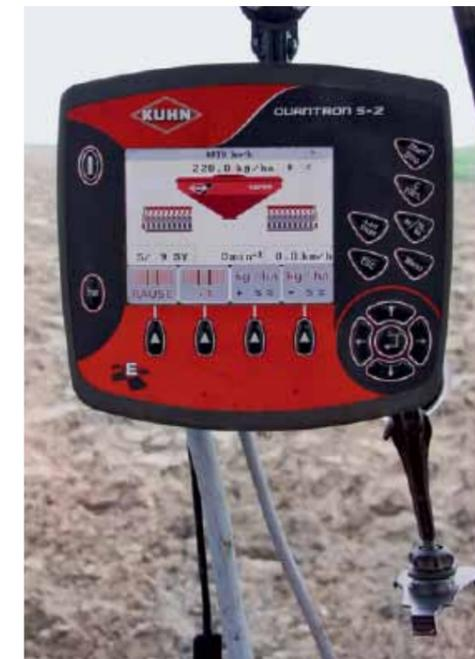
Das Quantron-S-2-Terminal bietet im Vergleich zum Vorgänger einen größeren Bildschirm mit Farbanzeige und die Möglichkeit zur GPS-gesteuerten Teilbreitenschaltung.
