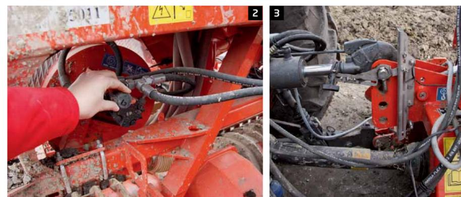
**1** Arbeitstiefe und Schardruck werden über Drehspindeln eingestellt. Macht man die horizontale Spindel länger, sät die Drille flacher und umgekehrt. Verkürzt man die vertikale Spindel, steigt der Auflagedruck und umgekehrt.
